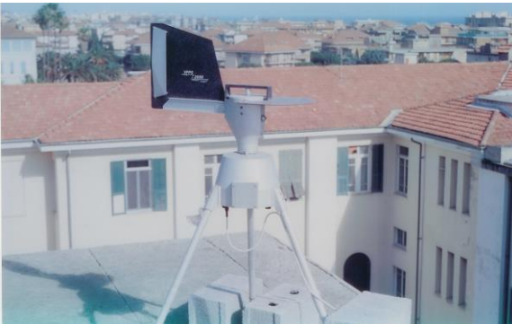
FIGURA 5 – Spore trap volumetrico Modello Lanzoni situato a Bordighera.
